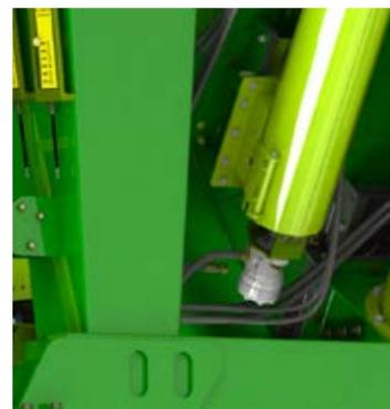
MOTOR HIDRÁULICO PARA ACIONAMENTO DO HELICÓIDE DA SEMENTE
