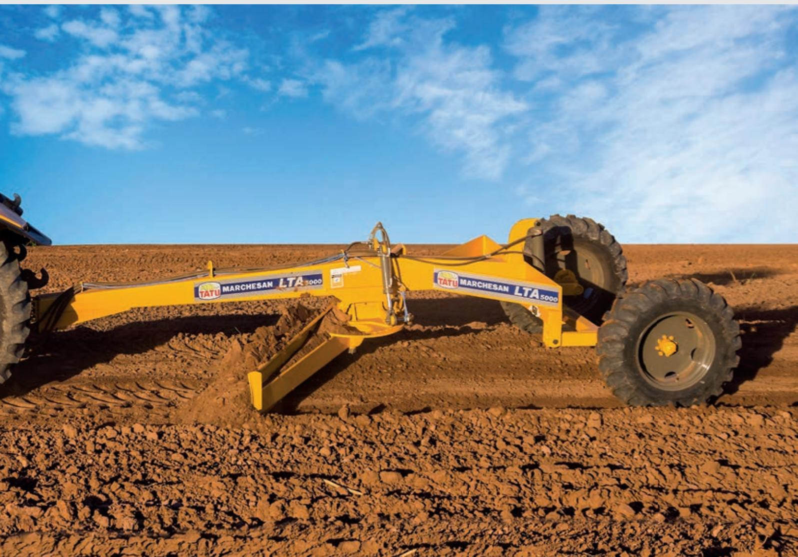
A LTA foi desenvolvida para realizar serviços de terraços, construção e manutenção de estradas, nivelamento do solo e eliminação de saliências e depressões em áreas da lavoura. Realiza tarefas semelhantes às de uma motoniveladora.
