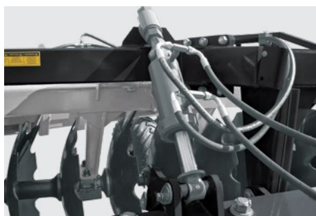
Pistão hidráulico para transporte e nivelamento da grade. Hydraulic Piston for Transportation and leveling of the disc harrow. Pistón hidráulico para el transporte y nivelación de la rastra aradora.
