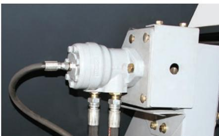
Motor hidráulico. Para o funcionamento do DCF 12000 com motor hidráulico, o trator deve possuir sistema hidráulico de fluxo contínuo e bomba hidráulica de 40 a 50 L/min.
