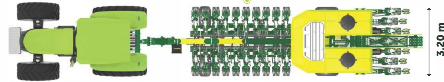
\* PARA OS MODELOS COM ESPAÇAMENTO DE 50 CM ENTRE LINHAS É NECESSÁRIO DESLOCAR AS LINHAS EXTERNAS DO MÓDULO CENTRAL E BANDAS EMPURRADAS (OPCIONAL) NECESSITAM SER REMOVIDAS PARA TRANSPORTE EMBARCADO.
